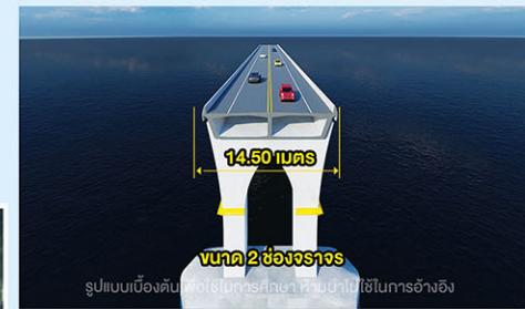
รูปตัดทั่วไปสะพานข้ามทะเลสาบสงขลา มีขนาด 2 ช่องจราจร (ไป-กลับ)
